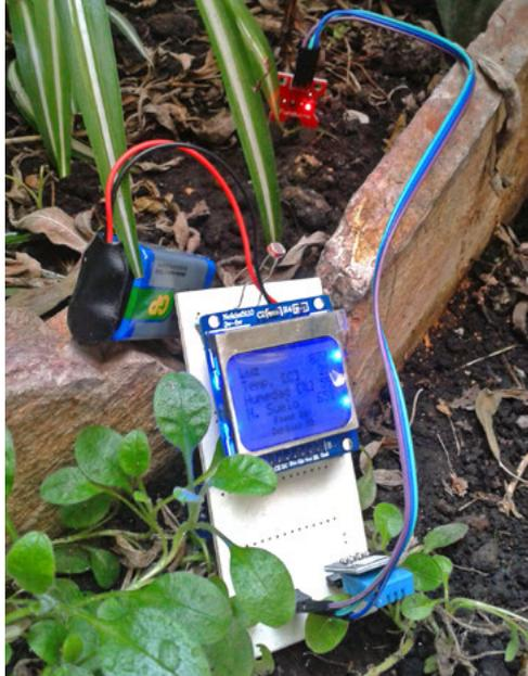
Dispositivo hecho con Arduino para medir humedad de la tierra, luz, temperatura y humedad del ambiente
